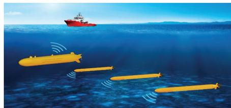
L'idée de départ a donc progressé, depuis la détection des cibles minières après cartographie systématique d'une région donnée par une flotte d'AUVs (Autonomous Unmanned Vehicles) et l'utilisation de la signature magnétique spécifique des amas sulfurés, jusqu'à l'acquisition de données multiples permettant d'apprécier la qualité de l'environnement, la biodiversité, la sensibilité environnementale.
